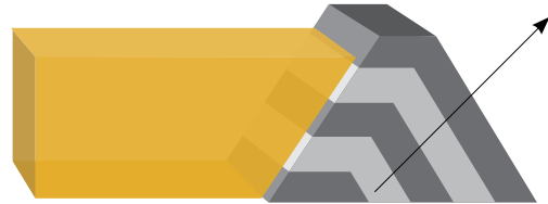
Downstream lifting manggunaon rekayasa batu, tano liat, dohot pasir na dipadatkan.
