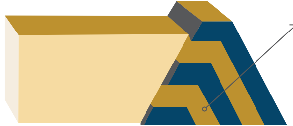
Downstream lifting using engineered compacted zones of rock, clay and sand Downstream lifting menggunakan rekayasa batu, tanah liat dan pasir yang dipadatkan
