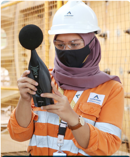
Safety Supervisor, OHS Triana Primadewi tengah menggunakan sound level meter untuk mengukur dan memastikan tingkat dan kontrol risiko kebisingan di sekitar area kerja Tambang Emas Martabe.
